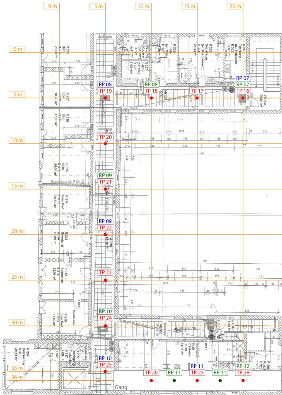
Abbildung 7.4: Gebäudeplan für die WLAN und GSM Messreihen auf allen Stockwerken. Zu sehen ist der Gebäudeplan des ersten Stockwerks des hinteren Sand 13. Eingezeichnet sind die TPs (rot), WLAN-RPs (grün) und GSM-RPs (blau). Das in der Messreihe verwendete Raster ist durch die orangenen Linien gekennzeichnet.
