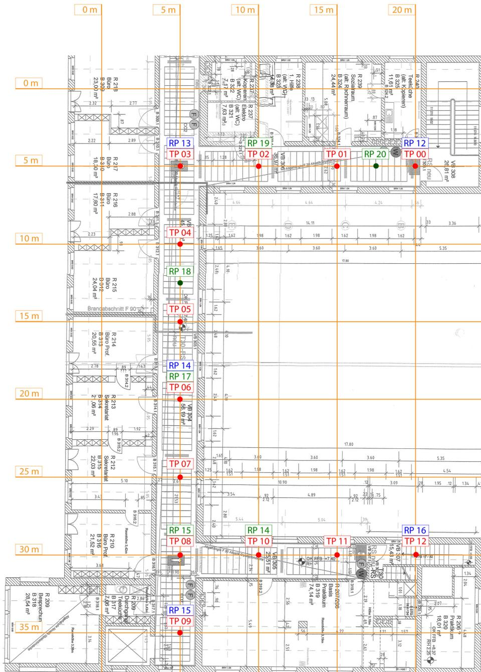
Abbildung 7.5: Gebäudeplan für die WLAN und GSM Messreihen auf allen Stockwerken. Zu sehen ist der Gebäudeplan des zweiten Stockwerk des hinteren Sand 13. Eingezeichnet sind die TPs (rot), WLAN-RPs (grün) und GSM-RPs (blau). Das in der Messreihe verwendete Raster ist durch die orangenen Linien gekennzeichnet.
