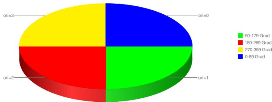
Abbildung 5.1: Quantisierung der vom elektrischen Kompass gelieferten Orientierung in der RTP in 4 Intervalle
