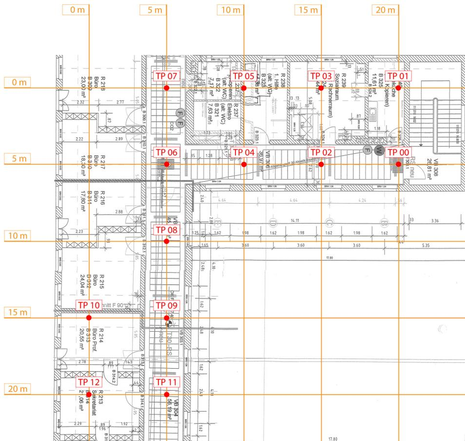
Abbildung 7.24: Gebäudeplan für die WLAN Messreihe im zweiten Stockwerk des hinteren Sand 13. Eingezeichnet sind die WLAN-TPs (rot). Die WLAN-RPs sind nicht separat eingezeichnet. Die Messungen wurden an allen WLAN-TPs ausgeführt. Das in der Messreihe verwendete Raster ist durch die orangenen Linien gekennzeichnet.
